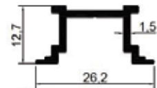
AD26-027 İSPANYOLET ADAPTÖR PROFİLİ 0,203 Kg/m
